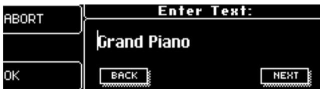
Den Performance-Namen ändern Sie mit den zwei Drehreglern. Mit dem linken Drehregler ändern Sie die Position durch Drehen und mit dem rechten Drehregler die Buchstaben. Eine Leerstelle erscheint bei Drehen des linken Reglers und durch Drücken des rechten Drehreglers gelangen Sie zum nächsten Buchstaben. Mit der OK-Taste (linke Taste) bestätigen Sie den Namen.
