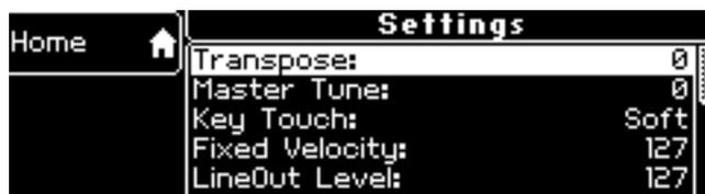
**Transpose:** Über Performance Edit gelangen Sie zu Transpose. Drücken Sie den rechten Encoder, um den Transposer anzuwählen. Nun können Sie mit dem Drehregler die gewünschte Transposition auswählen.
