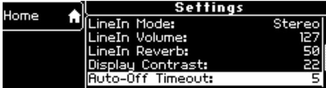
**Line In Mode:** Wählen Sie zwischen Stereo- und zwei Mono-Eingängen (Inputs). Die Line In-Anschlüsse finden Sie auf der Rückseite Ihres e-Klavier 3. Hier lassen sich einfach andere Geräte wie E-Gitarren, CD-Player, Laptops, Smartphones oder andere Keyboards, Synthesizer, Mikrofon, etc. anschließen.
