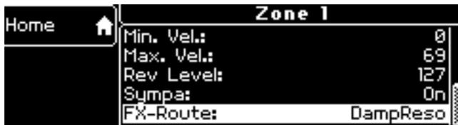
**FX-Route:** Hier wählen Sie den Pfad für den Multi-Effekt-Prozessor aus. Sie können zwischen DamperReso oder IFX (Internal Multi-Effekt) wählen. Damper Reso simuliert den Effekt, wenn die Filze der Saitendämpfung angehoben sind (wie bei akustischen Blüthner-Flügeln). IFX sind die Multi-Effekte wie Chorus, Panning, Tremolo und Phaser. Wenn IFX ausgewählt ist, können Sie diese Effekte im FX-Menü des Performance-Editors ändern (→ siehe Seite 18 – Edit FX).
