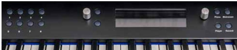
Links und rechts vom LCD-Display finden Sie die Dreh- und Druck-Encoder, mit denen Sie alle Funktionen des e-Klavier 3 anwählen können.
